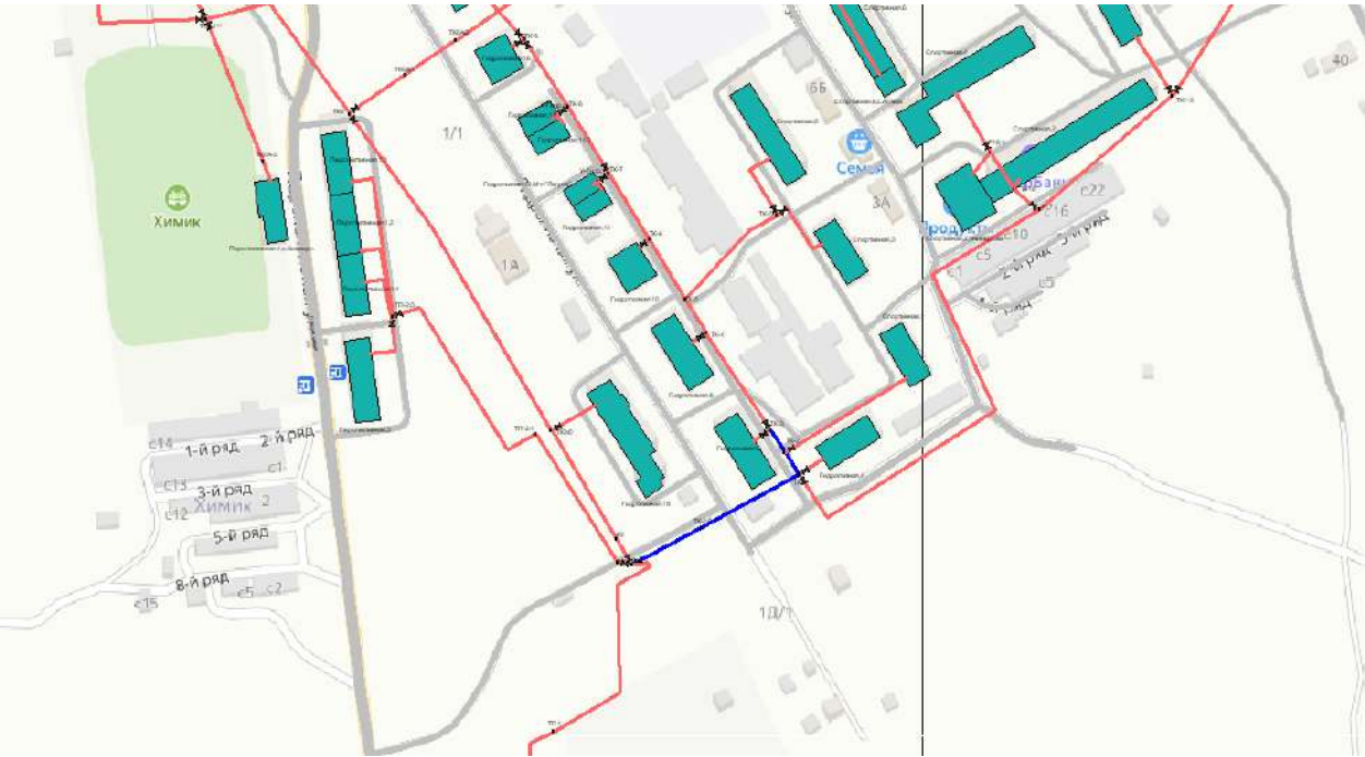
Рис. 36. Трубопроводы, перекрытые для проведения ремонтных работ.
