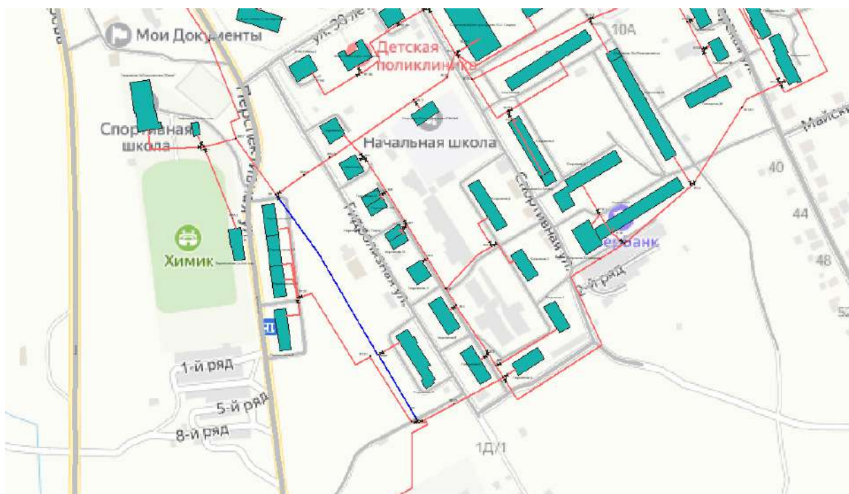
Рис. 33. Трубопроводы, перекрытые для проведения ремонтных работ.
