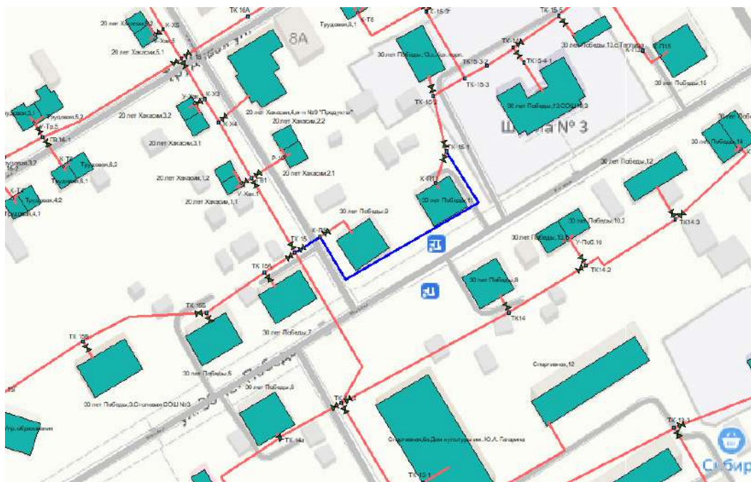
Рис. 42. Трубопроводы, перекрытые для проведения ремонтных работ.
