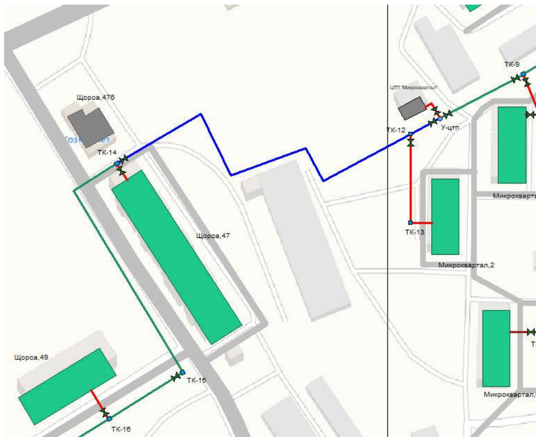
Рис. 84. Трубопроводы, перекрытые для проведения ремонтных работ.
