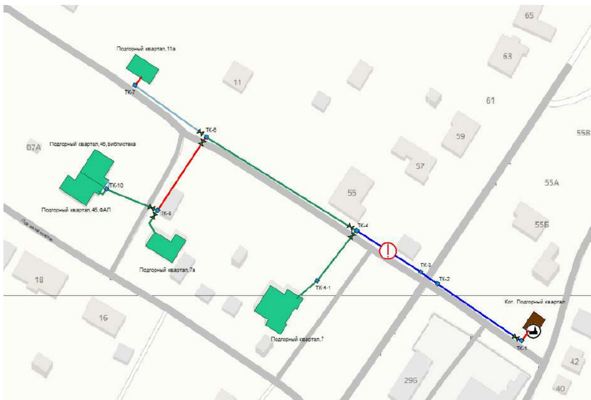
Рис. 13. Трубопроводы, перекрытые для проведения ремонтных работ.
