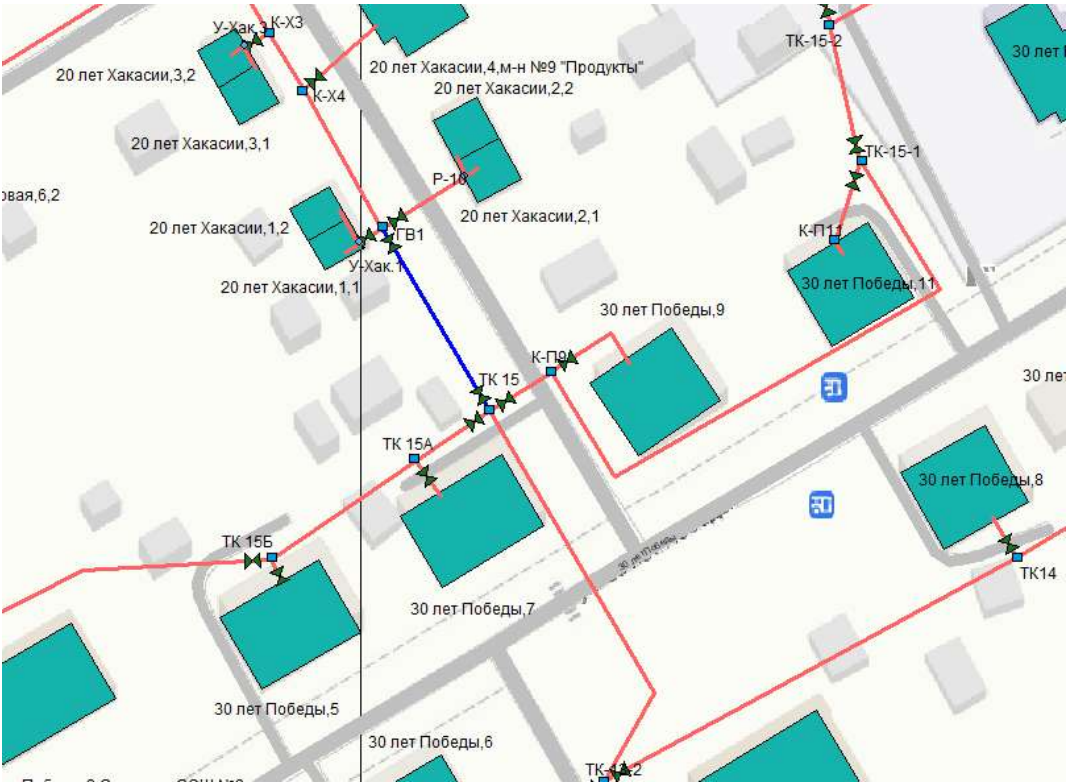
Рис. 39. Трубопроводы, перекрытые для проведения ремонтных работ.
