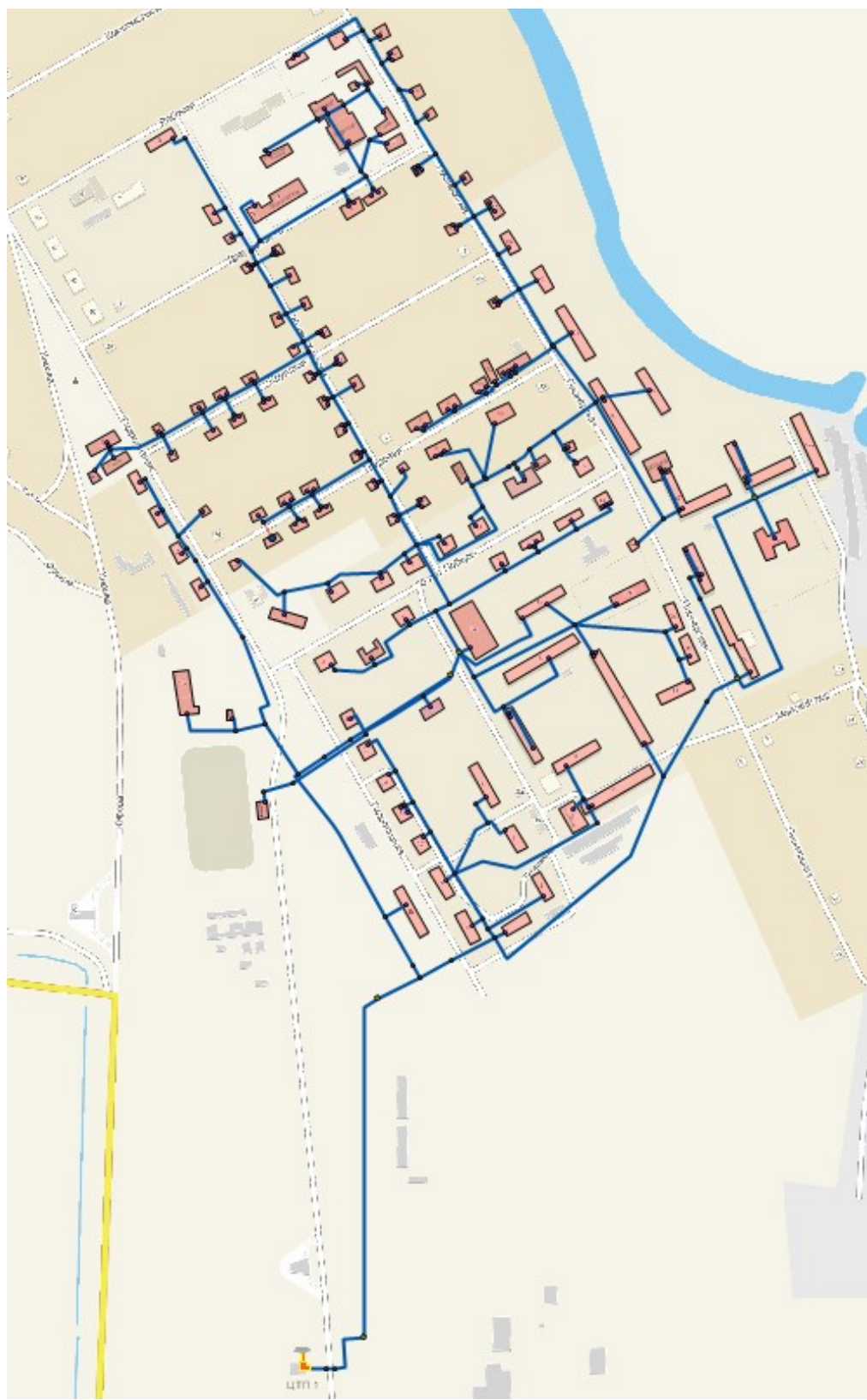
Рисунок 1.2 – Тепловые сети ЦТП-1
