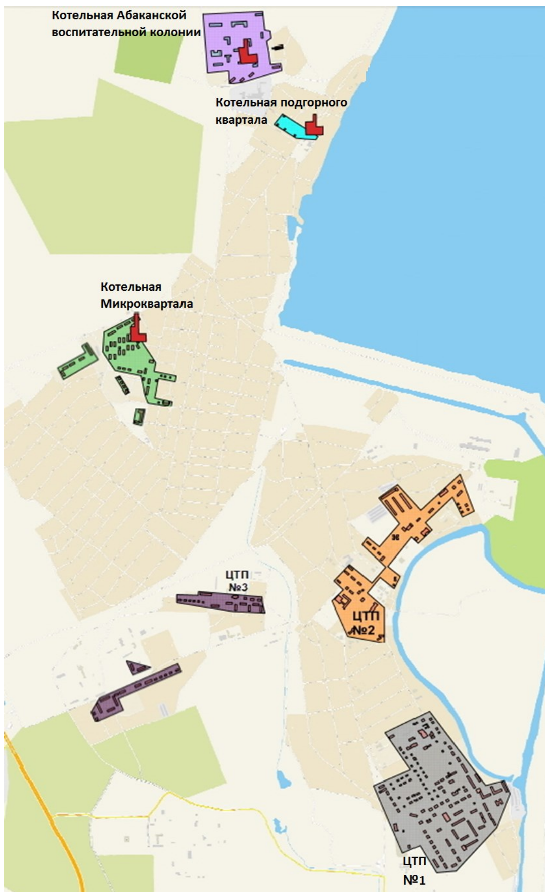
Рисунок 1.17 - Зоны действия систем теплоснабжения и источников тепловой энергии
